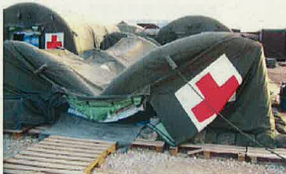
(エアードームの破損)
