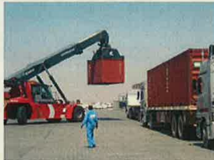
コンテナリフター、クレーン等 「コンテナリフター写真」
