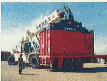
(Tレックスによる20ftコンテナ積載) (重レッカーによるトレーラ積載)
